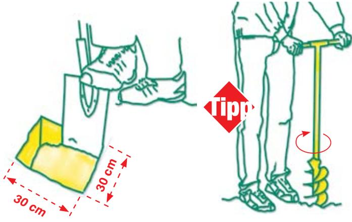
Ausheben der Fundamentlöcher mit ca. 30 x 30 cm. Die genau Tiefe (frostsicher bei ca. 80 cm) ist abhängig von der Pfosten-Höhe und der Lage der unteren
