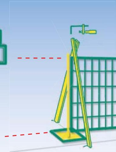
Matte mit Holzplatten und Schraubklemme fixieren. Jetzt eine weitere Matte anklemmen und den nächsten Pfosten ausrichten.
