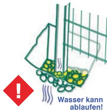
Um Korrosionsschäden zu vermeiden, sollte der Pfosten auf einer Schicht mittelgroben Kies stehen. Damit ist gewährleistet,
