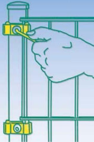
Matte mittels der Klemmplatten und Inbusschlüssel (5,5 mm) fixieren und festziehen.
