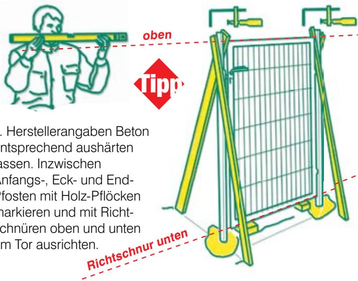
lt. Herstellerangaben Beton entsprechend aushärten lassen. Inzwischen Anfangs-, Eck- und End-Pfosten mit Holz-Pflöcken markieren und mit Richtschnüren oben und unten am Tor ausrichten.
