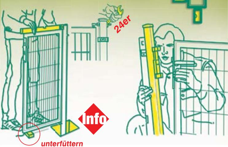
Für Tor-Pfosten Fundament-Löcher lt. Pkt. 03 erstellen. Tor-Flügel mit Holz-Keil unterfüttern und waagrecht ausrichten. Pfosten an zwei Seiten
