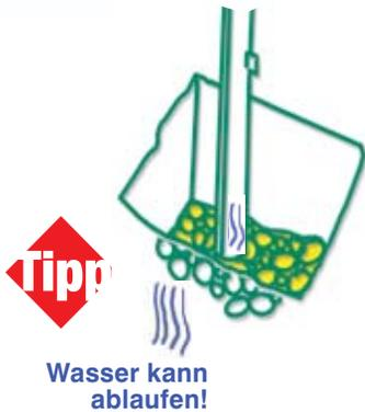
Um Korrosionsschäden zu vermeiden, sollte der Pfosten auf einer Schicht mittelgroben Kies stehen. Damit ist gewährleistet,
