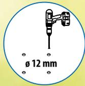
Die Löcher zur Bodenplattenbefestigung vorbohren und die Bodenplatten mit geeigneten Erdankern aufdübeln.
